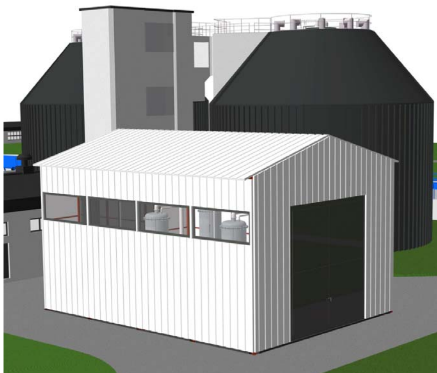
Слика 8. 3Д приказ модела постројења за пречишћавање биогаз од водониксулфида у оквиру постројења за пречишћавање отпадних вода
